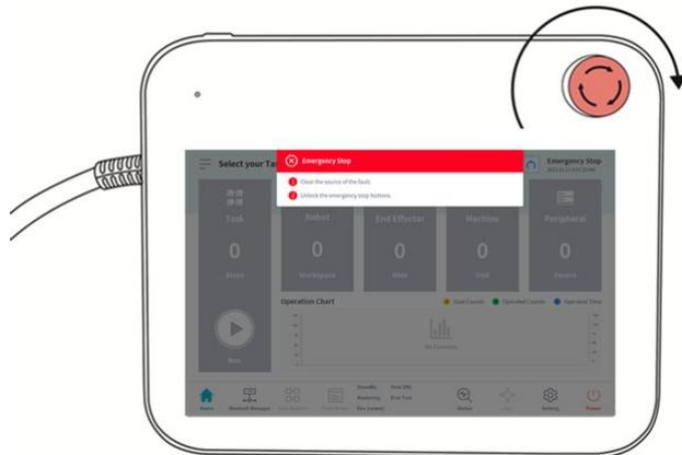
ロボットの設置後、最初のシステム起動後、ティーチペンダントの緊急停止ボタンが押されると警告ポップアップが表示されます。ロボットを操作するには、緊急停止ボタンを解除する必要があります。
