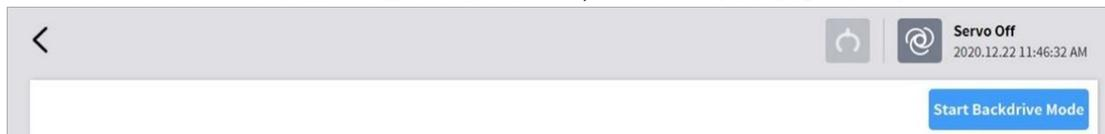
3. 移動させたいジョイントのブレーキをOFF(Release)で設定した後、ロボットに外力を加えて目的の位置に移動させてください。
